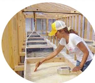
◀ 塩分濃度が濃くなった海水をこのビニールハウスの中で、結晶化するまでじっくり置きます。その間も混ぜ合わせる作業があり、それを怠ると結晶がバラバラの大きさになってしまうため、毎日作業は欠かせないそうです。
